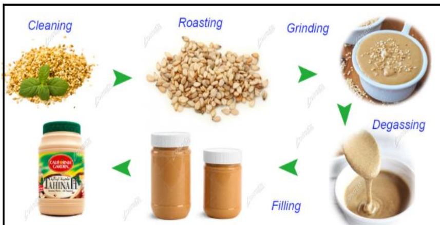
شكل (15) مخطط لإنتاج الطحينة السائلة
